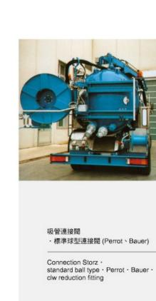
高壓水管捲盤 後置捲盤 - 樞軸旋轉,左右位移 自動或手動轉動捲盤 自動或手動排置水管 不銹鋼鑲編或強化紡織橡膠高壓水管 · 直徑 3/4" ~1-1/4",長度可達200公尺 ain hose reels pivoting and cross travel · automatic or manual swivel automatic or manual hose guide
